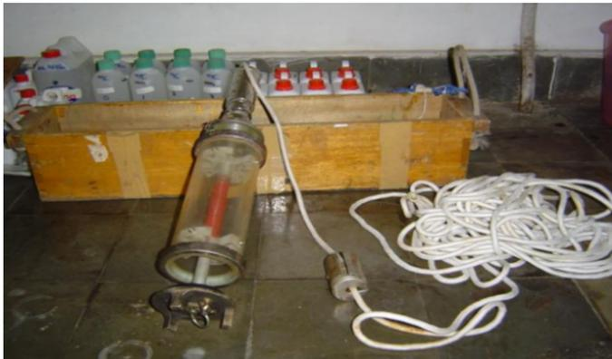
**Gambar 6.4:** Alat Sampel Air Vertikal
